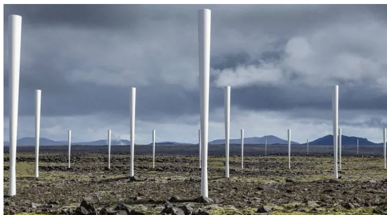
Рисунок 1. Безлопастный ветрогенератор Vortex Bladeless.
